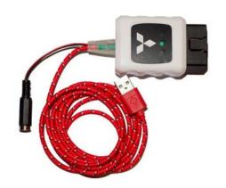
Адаптер ММС K-Line исполнения 3 (с мультиплексором) - представляет собой комбинированное устройство для чтения данных по шине K-Line(OEM и ISO стандарт) и протоколам ММС SCI с автоматической коммутацией блоков управления.
