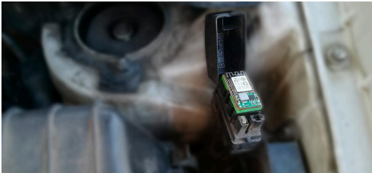
Рис.2 Установленный бескорпусной сканер Toyota-OBD1 в разъем DLC-1 (23 Pin) автомобиля Toyota
